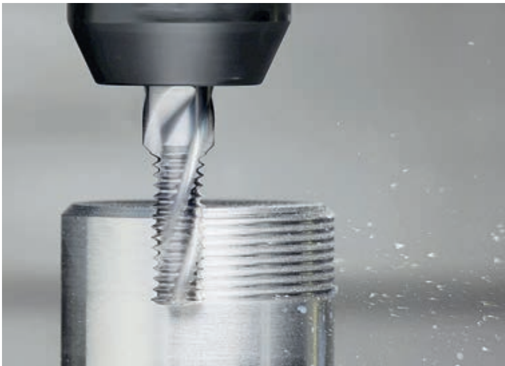
Ondanks dat een draadrees duurder is dan een tap leidt dit toch tot kostenverlaging. (Foto: Seco Tools)
